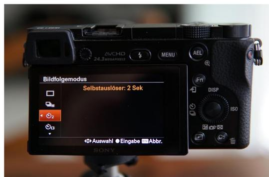
4. Besitzt die Kamera einen **Bildstabilisator** irgendeiner Art, sollte dieser **deaktiviert** werden. Die Kamera steht fest auf einem Stativ, weshalb nichts stabilisiert werden muss. Ist der Bildstabilisator aktiviert, besteht die Gefahr, dass die Kamera trotz Stativ nicht vorhandene Verwackelungen ausgleichen will und damit Verwackelungen erst produziert.
