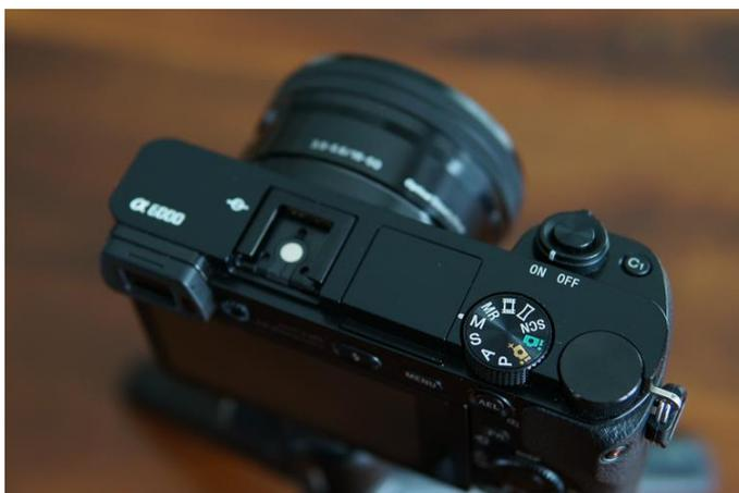
2. Auch der Fokus muss auf Manuell gestellt werden (**Manueller Fokus**; MF). Bei einigen Objektiven kann man am Objektiv selbst einen Regler auf MF schieben. Unter Umständen gibt es auch eine besondere Taste an der Kamera. Ist das nicht der Fall, muss im Kameramenü in den manuellen Fokus gewechselt werden.
